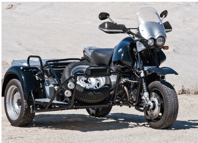
Das Gespann in der vorletzten Ausbaustufe mit großen Zusatztanks unter dem einklappbaren Beifahrersitz. Die noch »serienmäßigen« EML-Federbeine erwiesen sich aber als nicht besonders pistentauglich.
